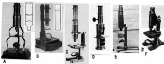
図2 江戸時代後半から明治初頭までに到来し由緒が比較的明らかな顕微鏡を年代順に並べました。A) 天明7年1787、カルペッカー型、倍率x21、京都川井家蔵 B) 1820-1840、箱台付木製簡易型、x41、武田杏雨書屋蔵 C) 1850~、ベルリン製小型金属顕微鏡、倍率不明、京都小石家蔵 D) 1860~、ドイツ製筒型顕微鏡(ドラム型)、x110、西周旧蔵津和野郷土館蔵 E) 1867前後、英国マーチン型? x47~x90、三宅秀旧蔵 F) 1867前後、オーストリアのライヘルト型? 倍率不明、高松凌雲旧蔵函館五稜郭分館蔵。AB挿入図は鏡筒横断面レンズを示す。
